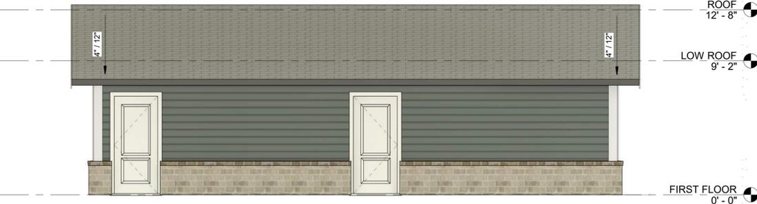
**2 MAINTENANCE BUILDING - LEFT SIDE ELEVATION**
