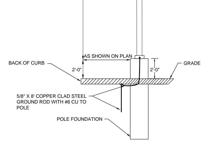
2 SITE LIGHTING LUMINAIRE POLE DETAIL LUMINAIRE TYPE 'PL'
